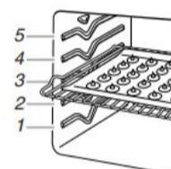
Pour déplacer une grille, la tirer jusqu'à la butée, soulever l'avant puis la retirer. Se servir des illustrations et des tableaux suivants comme guide pour le positionnement des grilles.
